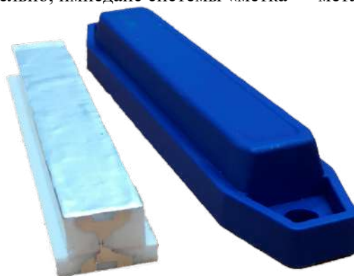
Рис. 1. Исследуемая метка без корпуса (слева) и в корпусе (справа)
