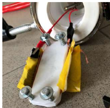
Рис.2 многослойная ЛКА ячейка с подводом кислорода с торца
