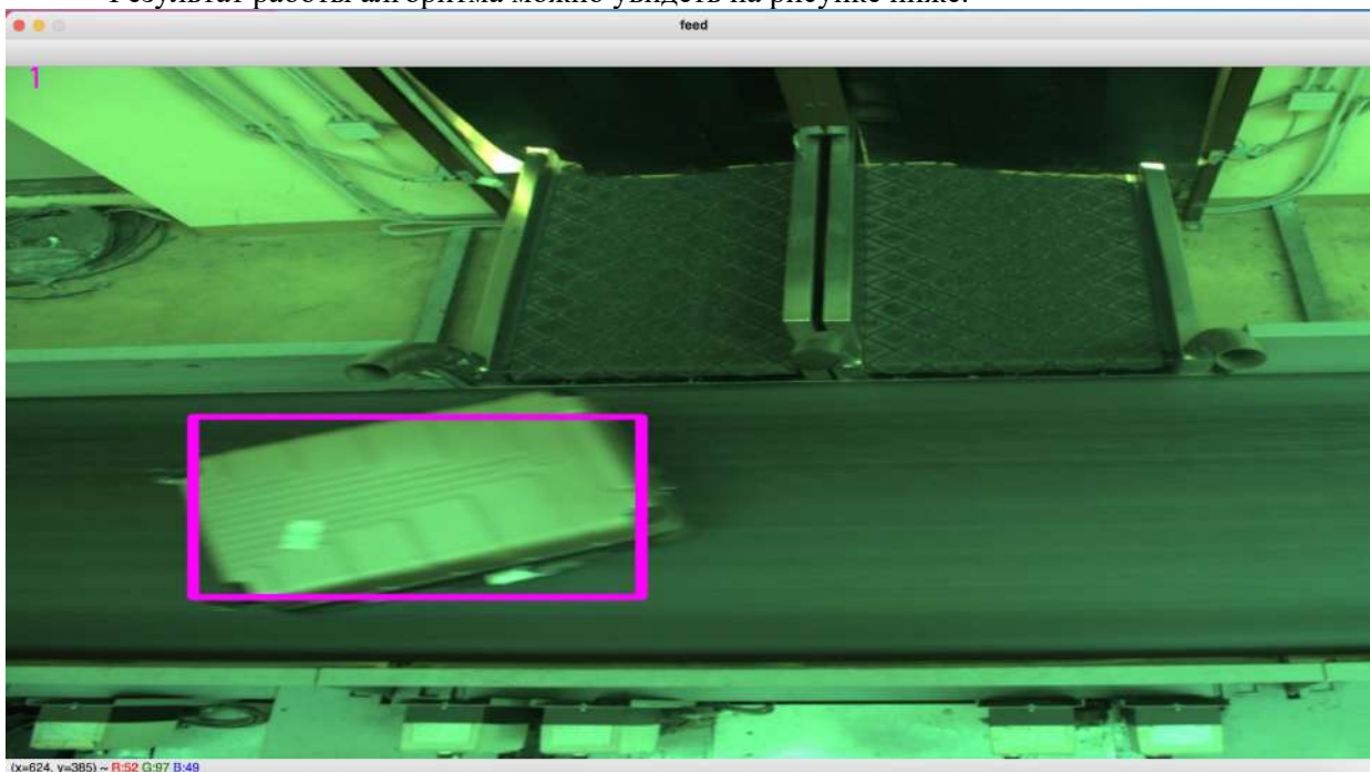
Рис 1. Результат работы алгоритма рамка с чемоданом и в левом верхнем углу количество объектов
