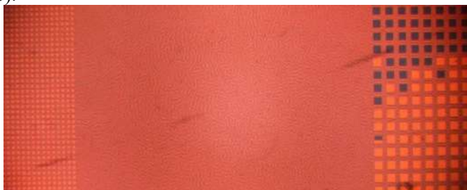
Рис. 1. Ячейки ПВМС и исходная пленка феррита-граната.
