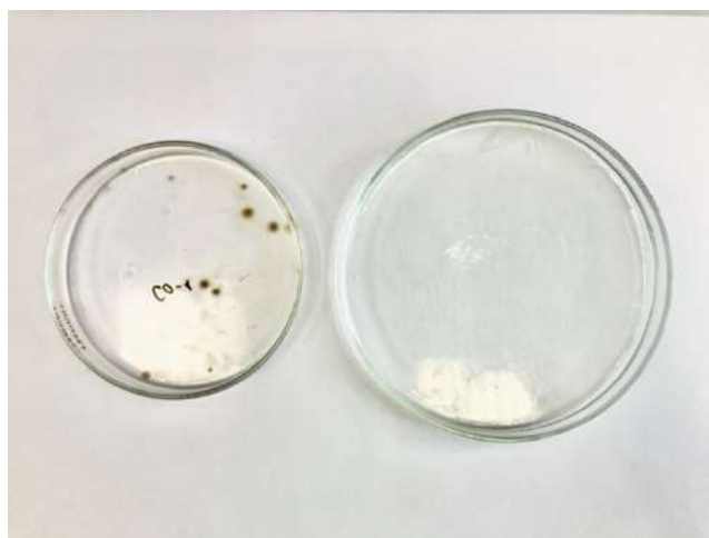
Рис. 1. Плёнки из каппа-каррагинана, гидроксипропилметилцеллюлозы, глицерина и воды; слева – без добавления антиоксиданта; справа – с добавлением антиоксиданта (бензоат натрия).
