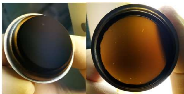
Рис. 2 – Результаты нанесения черного алюминия на экран
