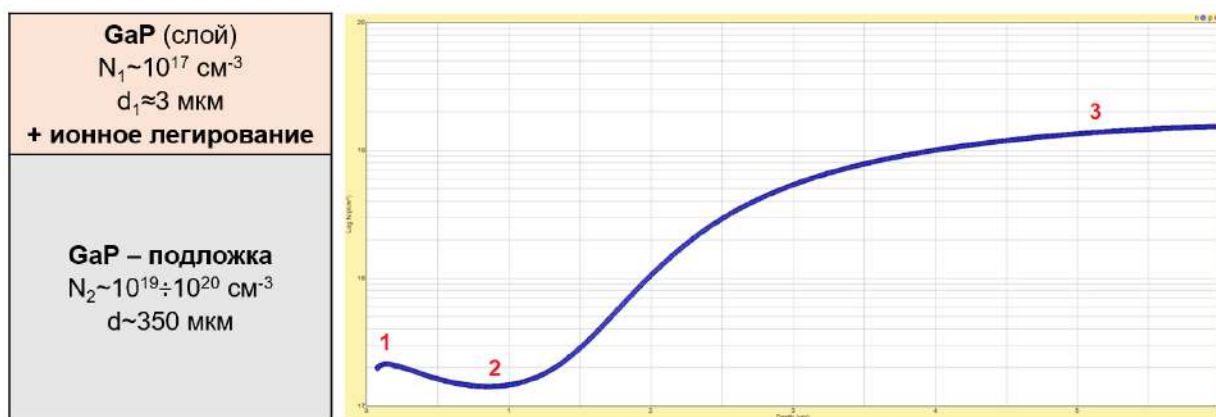
Рис. 1. Эпитаксиальная структура на основе GaP: а) топология структуры; б) экспериментальный ECV-профиль.
