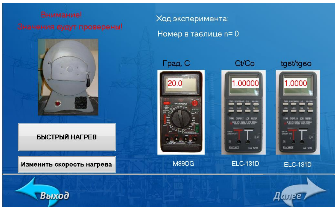
Рис. 2. Изображение экспериментальной установки к лабораторной работе «Исследование влияния температуры на емкость конденсатора и диэлектрические потери в нем»
