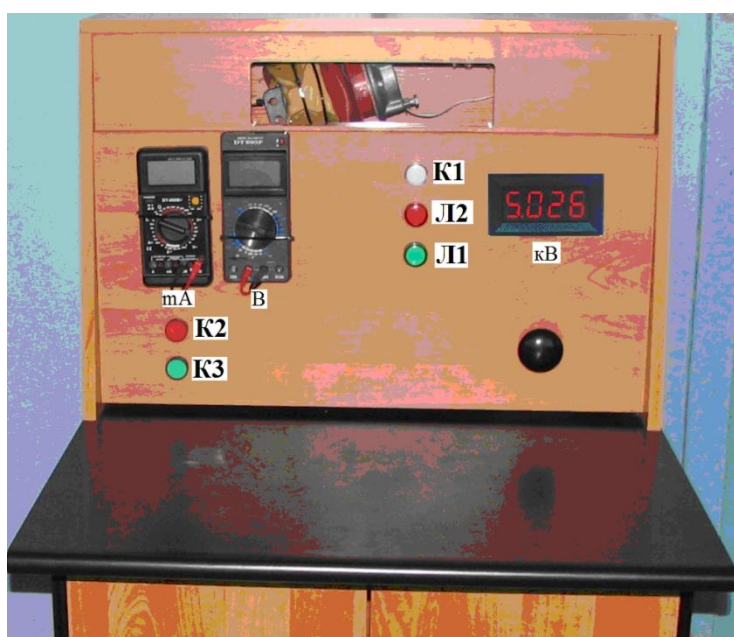
Рис.9. Изображение экспериментальной установки к лабораторно-практической работе № 4 на ЭВМ «Исследование нелинейных сопротивлений ограничителей перенапряжений».
