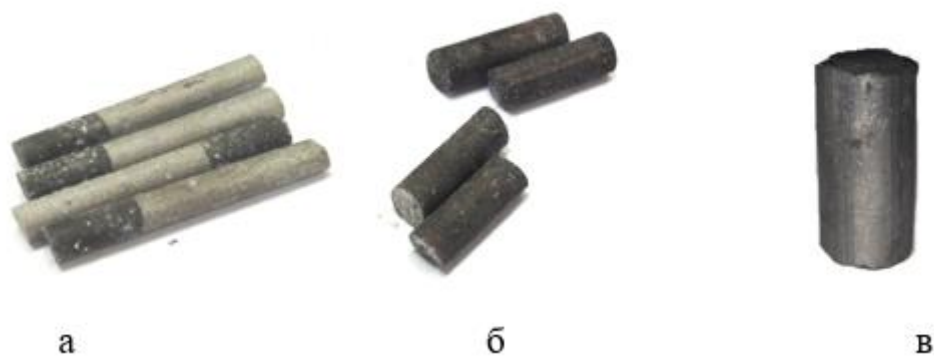
а – Пропитанная заготовка на основе Al – W – В4С, б – Пропитанная заготовка системы Al – WO 3 – В4С в – Пропитанная заготовка системы W – РЬ Рисунок 1 – Заготовки полученных композиционных материалов
