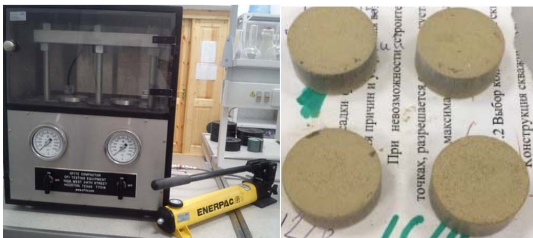
Рис. 2 Компактор производства OFITE, глинопесчаные образцы (слева направо)
