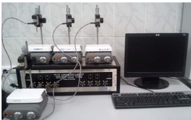
Рис. 3 Тестер продольного набухания производства OFITE
