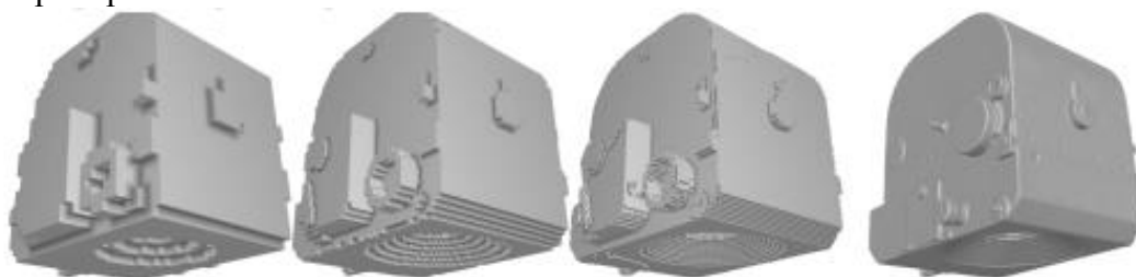
Рисунок 1 – 3D объект, представленный в следующих видах: воксельные модели с различными разрешениями (16000, 32000, 64000 вокселей) (левые 2 рисунка); полигональные модели объекта (правые 2 рисунка).
