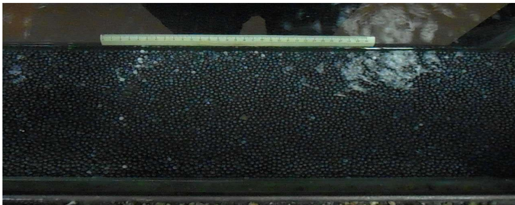
Рис. 2. Плановый вид рабочей области лотка. Кадр из рабочей видеозаписи
