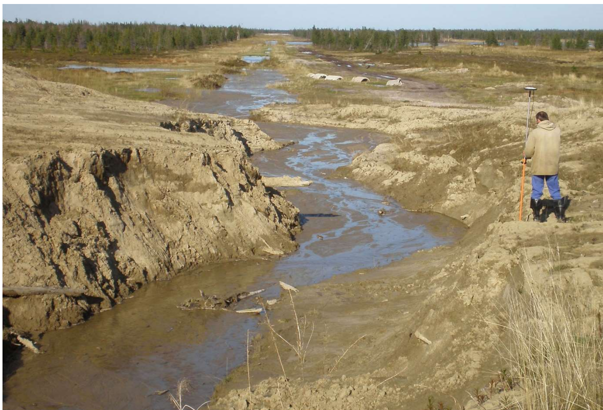
Рис. 2. Наземная топогеодезическая съемка оврага с применением спутникового оборудования
