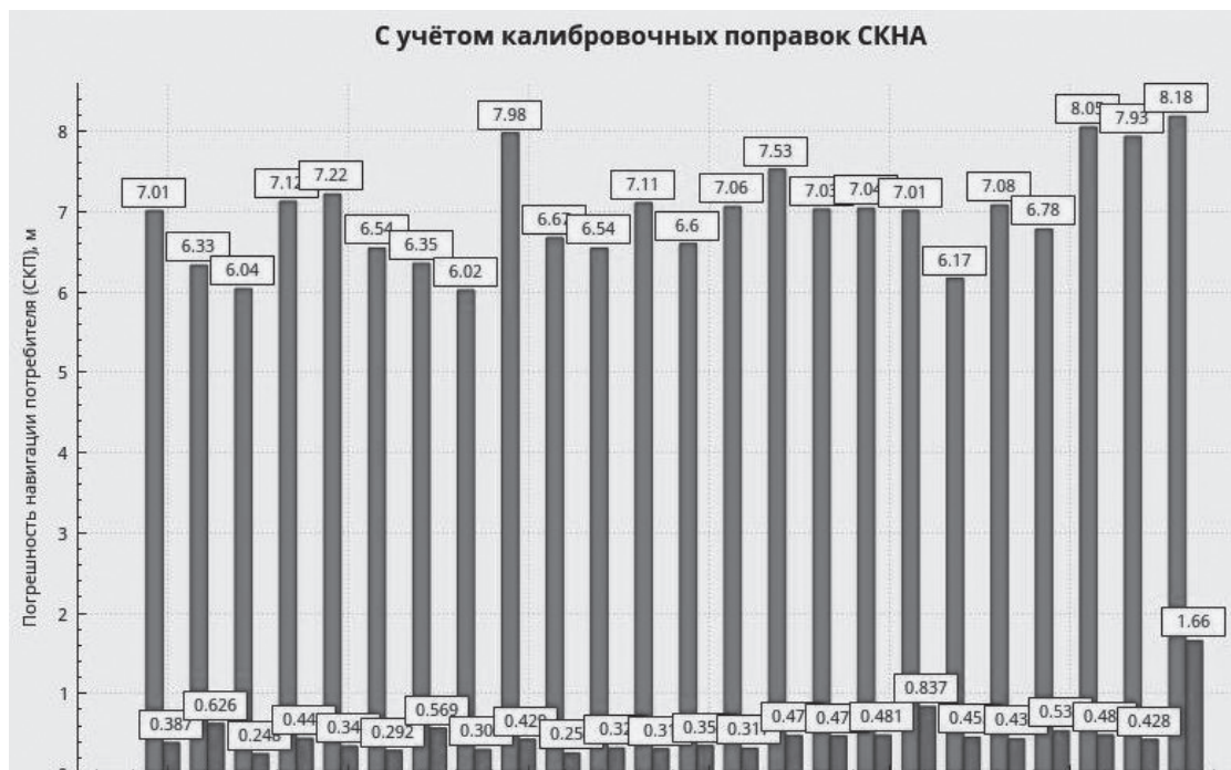
Рис. 2. Значения погрешности НАП с учетом (верхняя часть рисунка) и без учета (нижняя часть) калибровочных поправок (опорный пункт Щелково)
