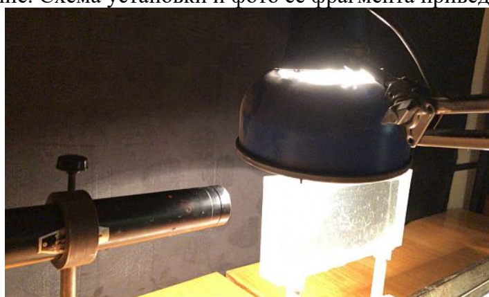
Рисунок 5 - Фото части установки. Нагрев поверхностного слоя воды лампой
