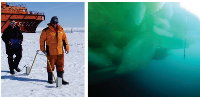
Рис. 1. Процесс измерений толщины морского льда георадаром Лоза В (слева) и пример нижней поверхности наслоенного льда (справа).
