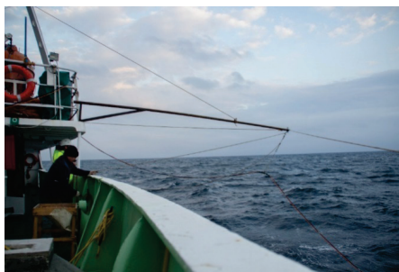
Рис. 3. Спуско-подъемное и буксировочное оборудование на корме НИС «Профессор Водяницкий»: а – траловая лебедка (для буксировки носителя антенн акустического профилографа использовался левый барабан); б - П-рама.
