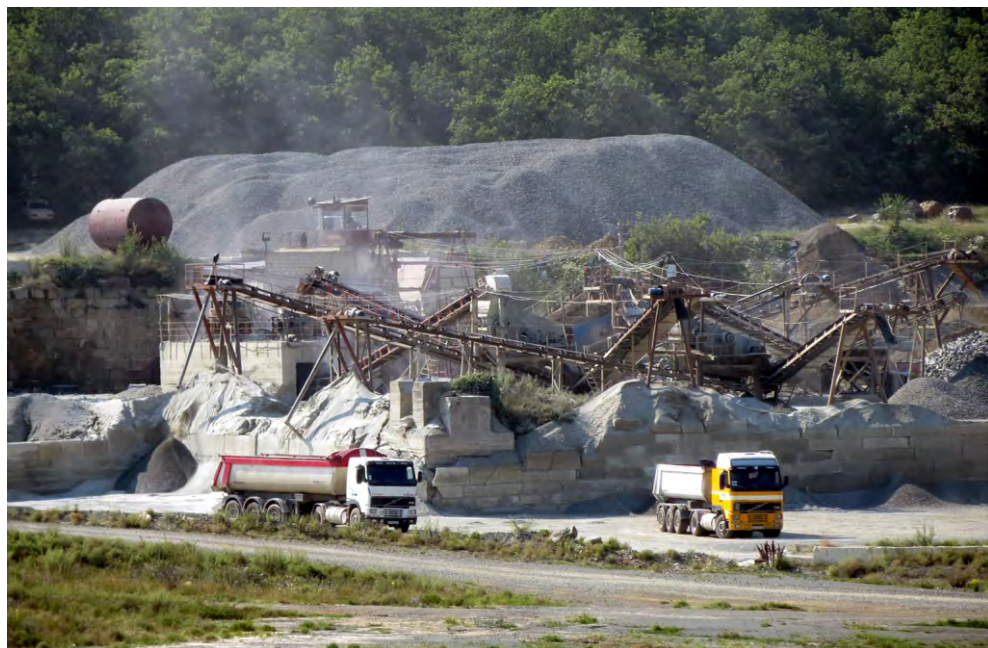
Рис. 59. Дробилка, на которой приготавливают щебень из габбро-диоритов Первомайского интрузива. Фото В.В. Аркадьева
