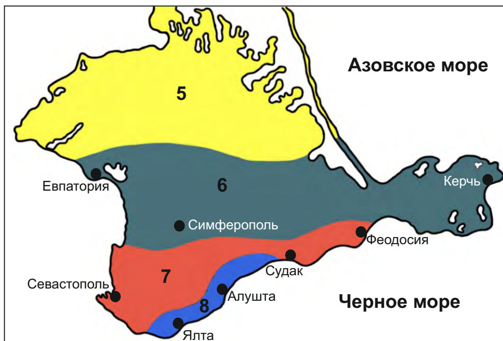
Рис. 187. Карта сейсмического районирования Крыма (Землетрясения в Крыму, 1990)
