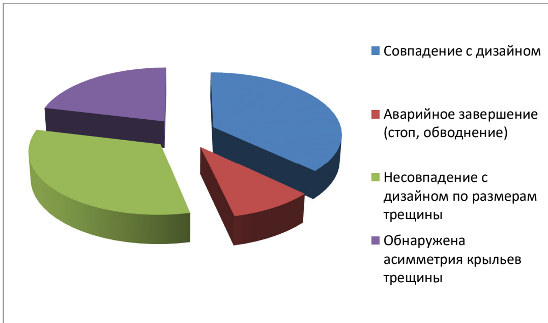
Рис.5. Диаграмма качества работ ГРП, выполненных в 2012-2017 г.г. для группы нефтегазоконденсатных месторождений в Западной Сибири.
