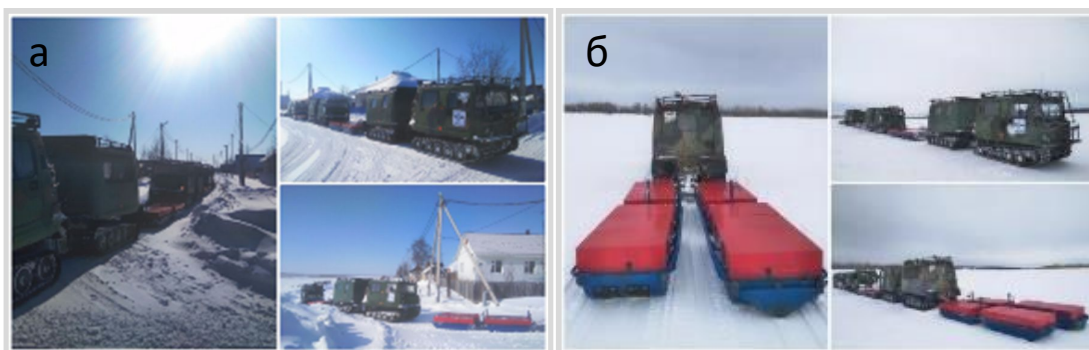
Рис. 4. Санные электромагнитные импульсные источники «Геотон-30», буксируемые гусеничным двухсекционным вездеходом BV-206 «Лось» в поселке «Вата» (а) и в акватории р. Обь (б).
