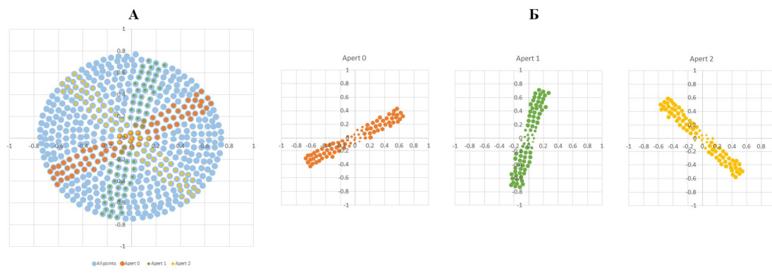
Рис.5. Выборка апертур анализа на мигрированной сейсмограмме для разделения отраженной волны и дифрагированных волн.
