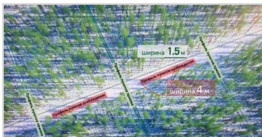
Рис. 5. Схема профилей по технологии «Зеленая сейсмика».
