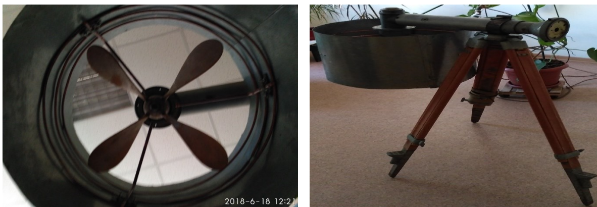
Рис. 2. Слева фотоснимок четырехлопастной вертушки (вид снизу) в корпусе ветровой защиты и справа фотоснимок общего вида приемного устройства на треноге (вид сбоку) без указателя скорости вертикальных потоков.
