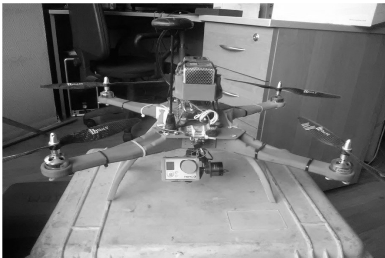
Рис. 1. 3D печатный квадрокоптер на базе арм 2.8 вид спереди версия сборки 1.2
