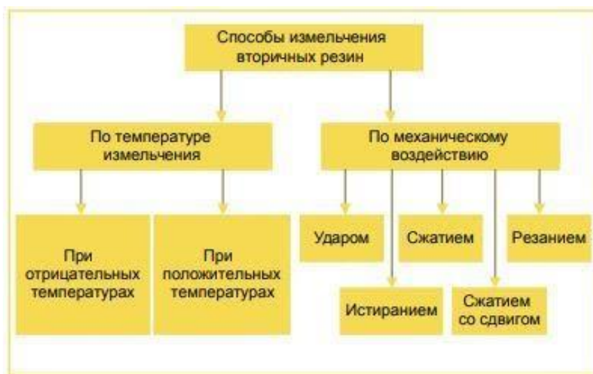
Рис.3. Способы измельчения шин
