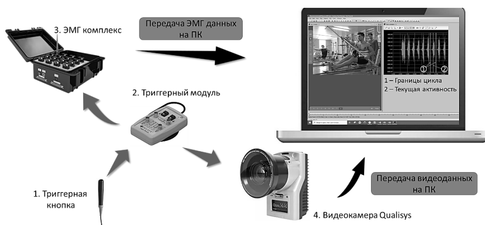
Рисунок 1 – Элементы осуществления синхронной регистрации ЭМГ и видео
