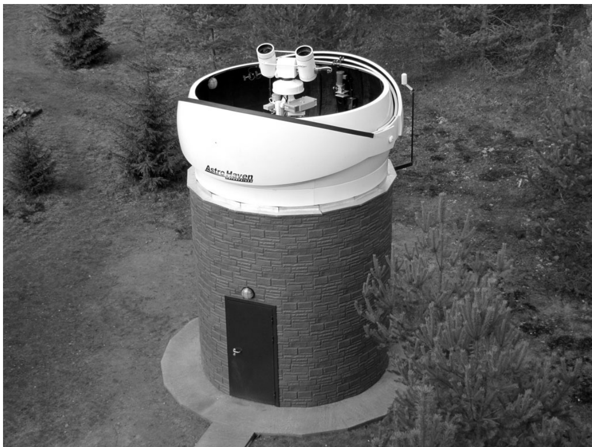
Рис. 3. Квантово-оптическая система «Сажень-ТМ» в обсерватории «Светлое»
