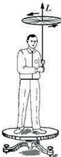
Рис. 2. Момент импульса колеса относительно вертикальной оси
