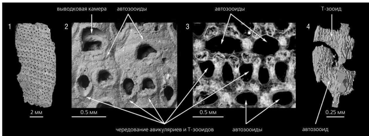
Колонии мшанок *Tobolocella levinae* из маастрихта Северного Казахстана [18]: 1 — общий вид колонии, 2 — зоид, изображения получены с помощью сканирующей микроскопии; 3 — продольный срез зоидов, 4 — 3D-модель зоидов, изображения получены с помощью микротомографии.
