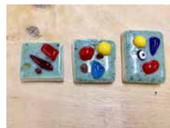
3. Слева направо. Образец под номером 1 был вынут из печи при температуре 750 °
