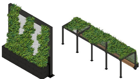
Рис. 2. Вертикальное озеленение: а. – Конструкция модуля для вертикального озеленения, б. – Навес
