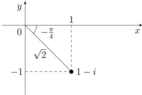
Получился прямоугольный треугольник с катетами 1 и 1. Этот прямоугольный треугольник равнобедренный. Его острый угол при вершине в начале координат равен  $\frac{\pi}{4}$ . Учитывая, что точка  $(1, -1)$  лежит в четвёртой четверти, в качестве аргумента комплексного числа можно взять отрицательное число  $\varphi = -\frac{\pi}{4}$ . После прибавления целого числа оборотов получим  $\varphi = -\frac{\pi}{4} + 2\pi k$ , где  $k \in \mathbb{Z}$ .
