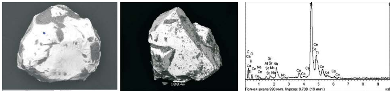
Рис.2. Двойники кубических кристаллов лопарита. Тяжелая фракция проб ЛО-1, ЛО-2, изображение в отраженных электронах.
