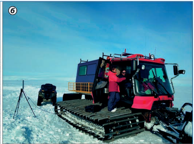
а – общий вид БПЛА ZALA 421-08М; б – общий вид наземной станции управления (НСУ) на базе тягача Kässbohrer PistenBully Polar 300; в – запуск БПЛА при помощи эластичной катапульты; г – парашютная посадка БПЛА
