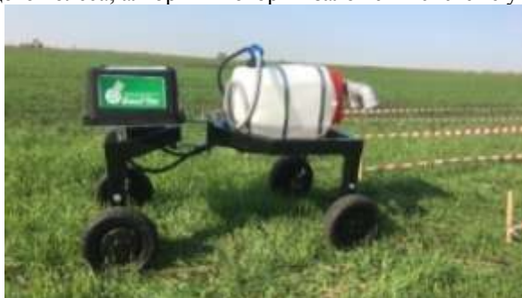
Рисунок 1. Беспилотный электроагрегат для внесения жидких удобрений через электростатическое поле
