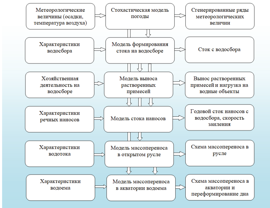
Рис. 3. Схема детерминированно-стохастической моделирующей системы IL_DSM для количественной оценки и прогнозирования массопереноса в системе «водосбор – водоток – водоем».
