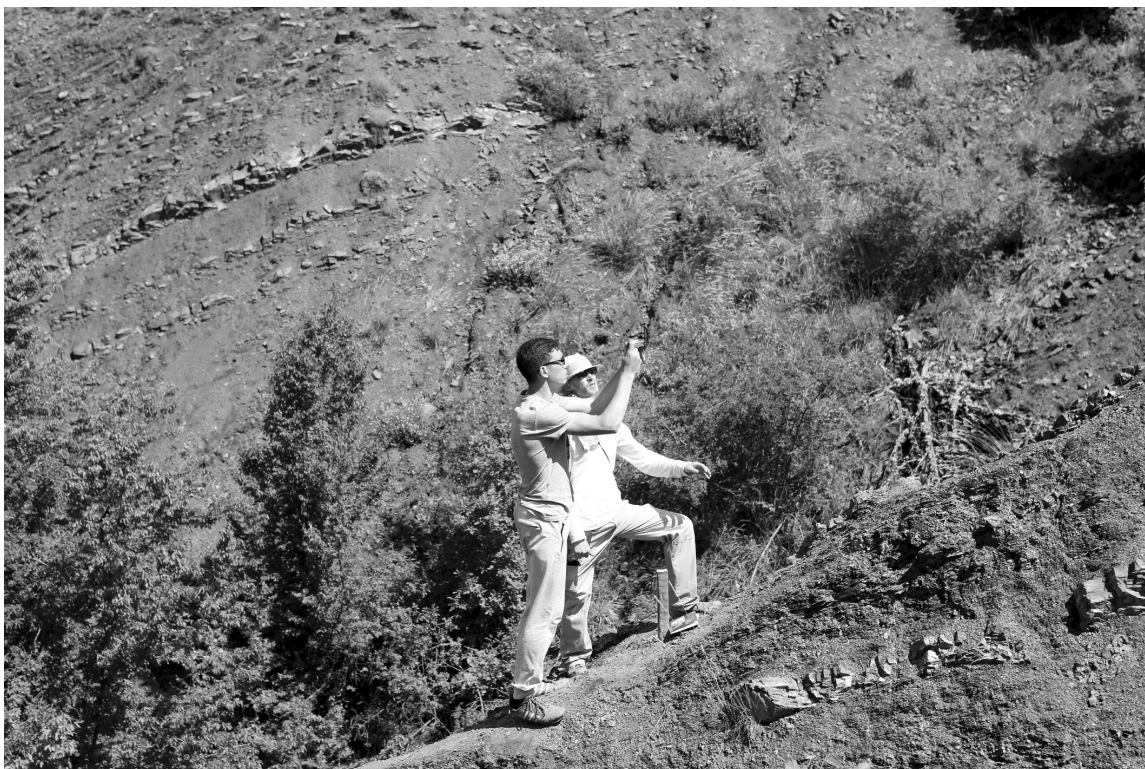
Рис. 2. Полуинструментальная привязка маркирующего горизонта. Измерение азимута направления с главного репера на один из пикетов осуществляется с помощью геологического компаса. Правый склон оврага Яман.
