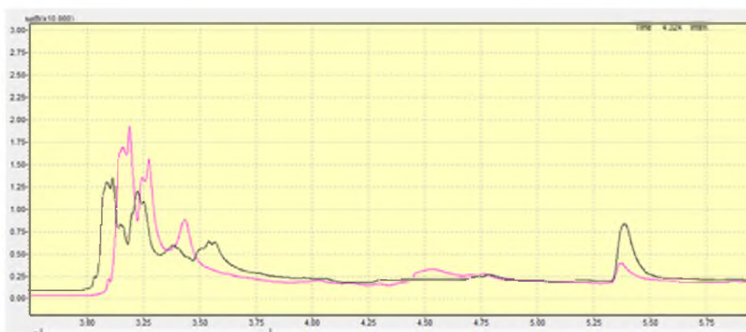
Рисунок 3. Газовая хроматография. Декан. Черная линия – декан без бактерий, розовая линия – декан с Rhodococcus erythropolis (108)
