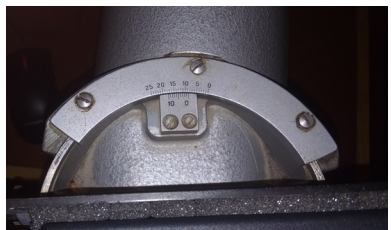
Рис. 6. Шкала угла наклона ПЗС линейки относительно оптической оси прибора.
