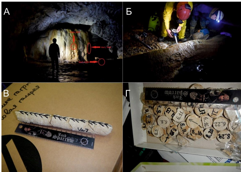
Рис. 2. Общий вид туфовой плотины с точками отбора отдельных кернов (А); ориентировка кернов in situ (Б); ориентированный керн Vor7 (Б); образцы-«шайбы» для магнитной чистки (Г)
