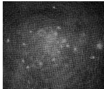
Рис.3. Поперечное сечение пучка с захваченными частицами. Для лучшей визуализации частицы были подсвечены красным лазером
