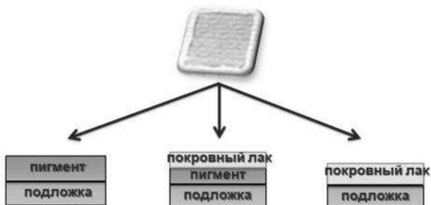
Рис. 1. Образцы для исследования оптических свойств краски и лака, а также для исследования процесса лазерной очистки
