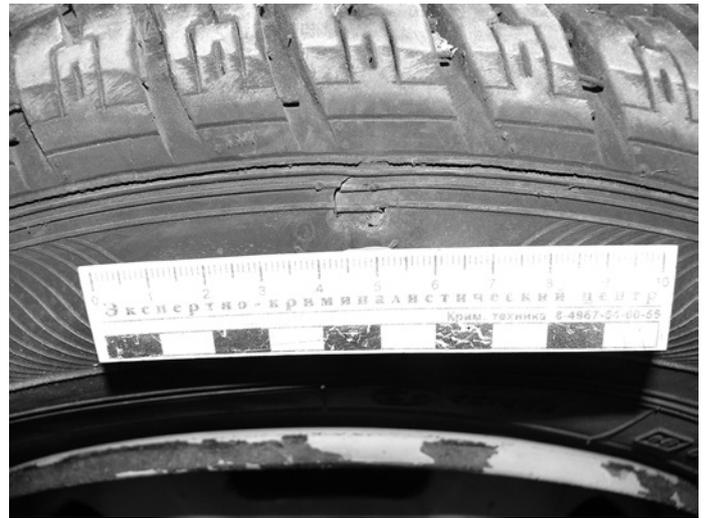
Рисунок 2. Сквозной пробой боковой поверхности шины
