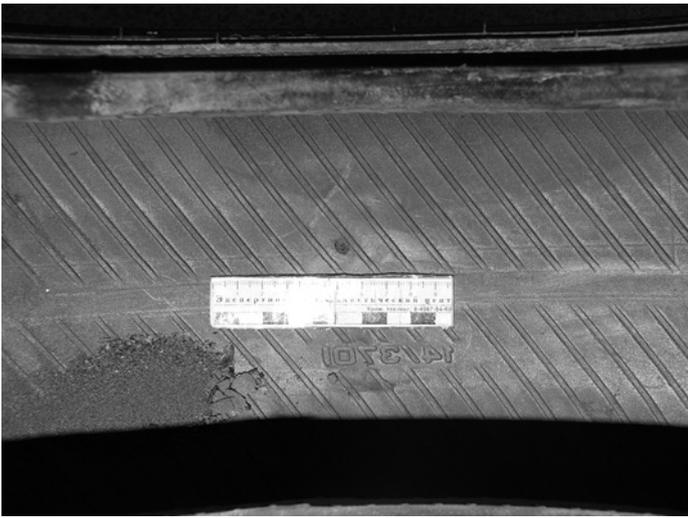
Рисунок 1. Сквозной прокол шины колеса
