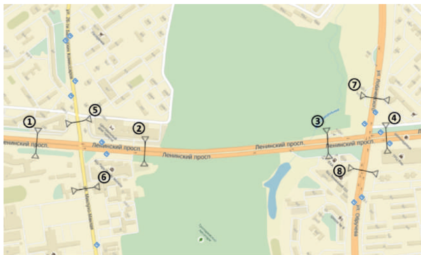
Рис. 3.2. Перекрестки на пересечении Ленинского проспекта с улицами Лобачевского и 26 Бакинских комиссаров г. Москвы. Расположение датчиков, измеряющих интенсивность и скорость транспортных потоков по дорожным полосам, показано цифровыми маркерами № 1–8
