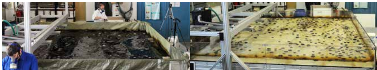
Рисунок 1. «Волновой бассейн» после добавления биосорбентов (слева) и через 24 ч (справа).
