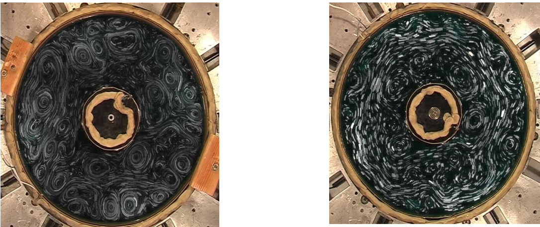
Рис.6 (а) – Закольцованные в укрупненные вихри узкие струи и (б) – широкая протяженная струя в канале 2 в покоящемся канале–(а) и (б)–при вращении T=67 сек.
