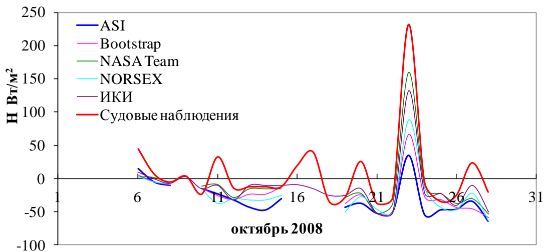
Рис. 5. Среднесуточный поток тепла, рассчитанный с использованием данных о сплоченности ледяного покрова, полученных из визуальных судовых наблюдений и различных алгоритмов обработки спутниковых пассивных микроволновых данных.
