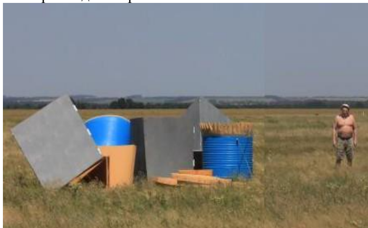
Рис. 1. Трехкомпонентный доплеровский минисодар высокого разрешения ВРМС. Слева: упрощенная блок-схема. Справа: антенны ВРМС в шумозащитных экранах на Цимлянкой научной станции ИФА, июль 1918 г. Цилиндрические синие экраны защищают приемные антенны от внешних акустических шумов и от просачивания излучаемого сигнала; треугольные призматические серые экраны подавляют боковые лепестки излучающих антенн.
