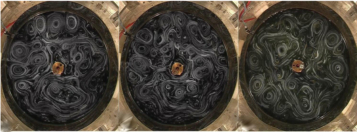
Рис. 4 Образование вихревых кластеров в канале 1: а) период вращения T=15.4 сек.; б) период вращения T=15.4 сек.; в) период вращения T=19.1 сек.
