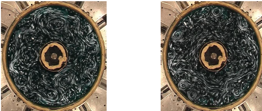
Рис.5 Выраженные узкие струи, канал 2, h = 24 мм, а) T=67 сек, б) T=39.8 сек.
