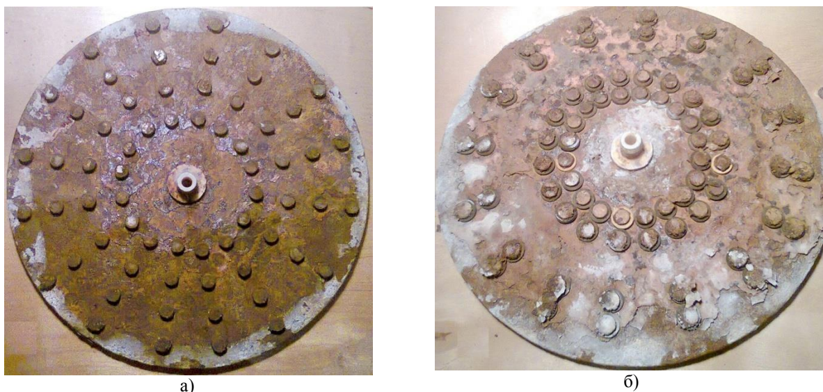
Рис.2 Расположение постоянных магнитов для канала 1 с 16 лучами с равномерным (рис.1а) и с более частым расположением магнитов на двух внутренних окружностях (рис.2б).
