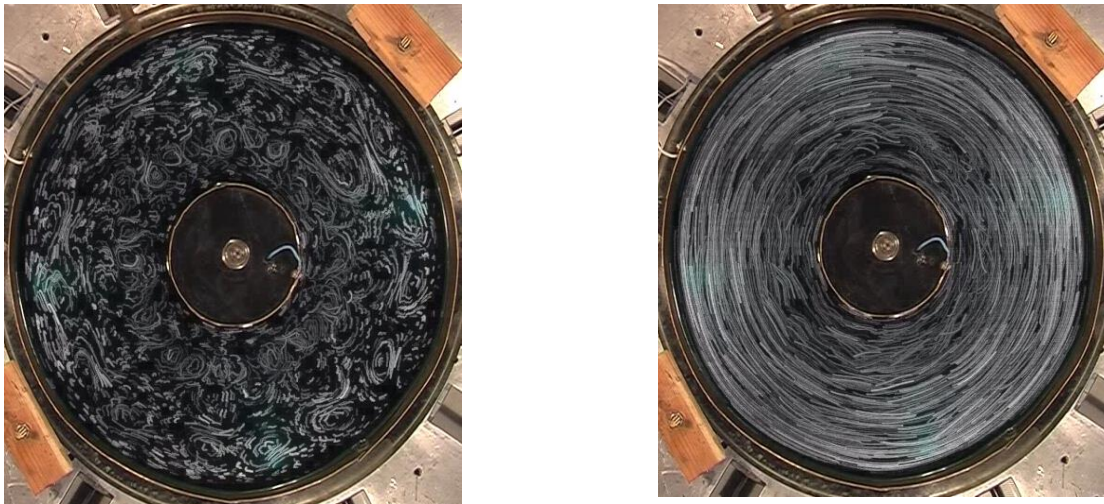
Рис. 13 Случайные возмущения и круговой вихрь, канал 2, эксперимент с быстрым вращением ( T=5.8 сек) и толщиной слоя у внутренней границы h=10 мм. а) кадр №500; б) кадр №1200.
