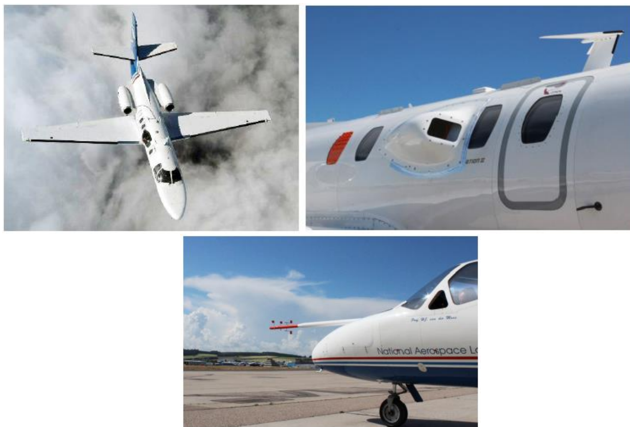
Рис. 3. Самолет Cessna-citation-2: вверху слева – общий вид, вверху справа – борт с выступающим окном, пропускающим ультрафиолетовое излучение, внизу – носовая штанга с дополнительным оборудованием.
