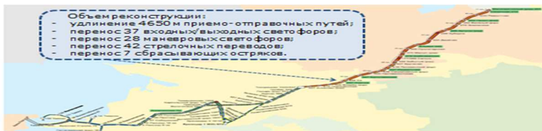
Рис. 10. Объем реконструкции станций на участке Вышестеблиевская-Котельниково
