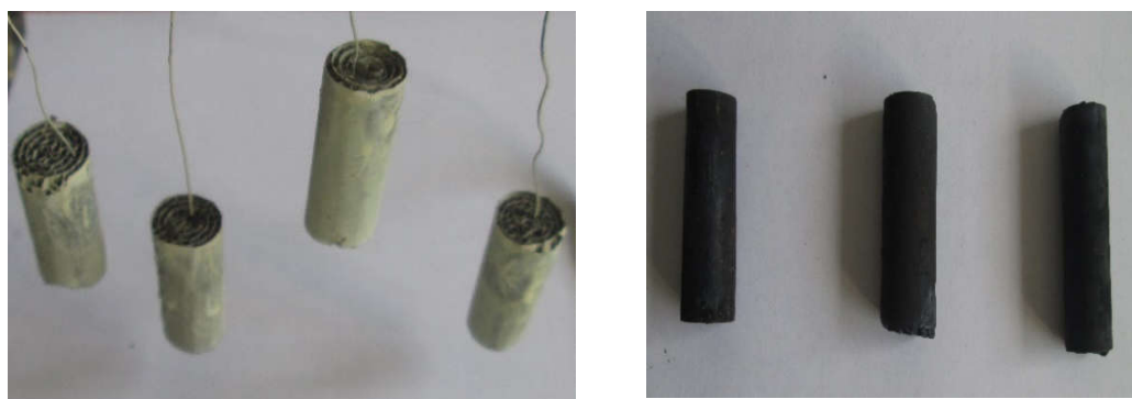
Рисунок 2 – Лабораторные образцы блочных катализаторов: а – пропитанный вторичным носителем блок; б – готовый нейтрализатор
