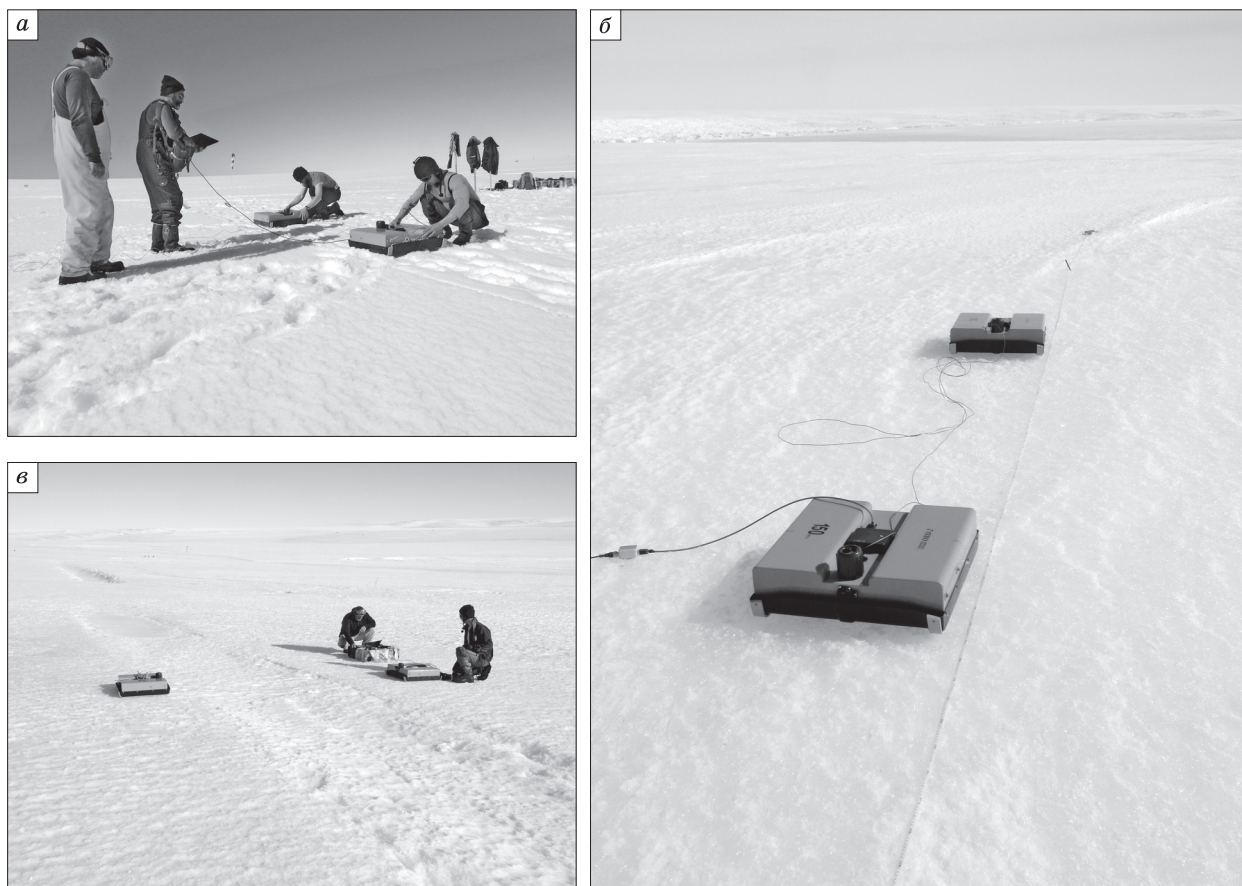
Рис. 6. Выполнение наклонных зондирований по системе ОГТ.
