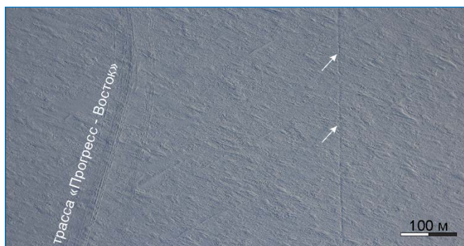
Аэрофотоснимок, выполненный в районе трассы следования СГП «Прогресс – Восток». Трещина в теле ледника показана белыми стрелками. Фото С.С. Пряхина.
