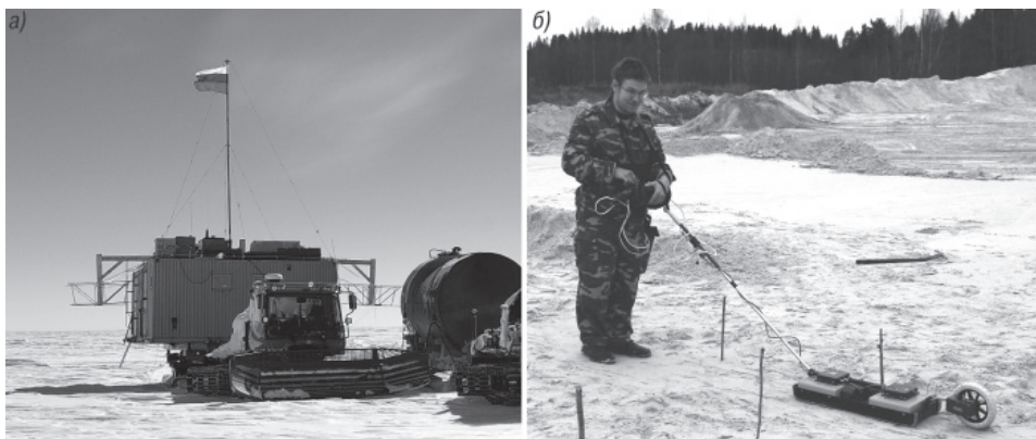
Рис. 1. Техническое оснащение современных отечественных наземных радиолокационных исследований: а — научный санно-гусеничный поход, Восточная Антарктида (январь 2009 г.); б — опытно-методические георадарные работы на карьере «Новинка», Ленинградская обл. (ноябрь 2011 г.). Фото С.В. Попова.
