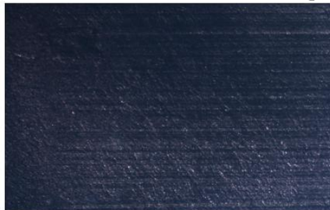
Рис. 3. Увеличенные следы внутренней поверхности канала ствола на слепках с пыж-контейнера
