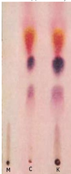
Рисунок – Пластина с исследуемыми образцами, проявленная реактивом Марки
