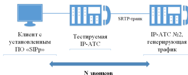
Рис. 1. Схема тестирования IP-АТС Elastix без использования протоколов ИБ
