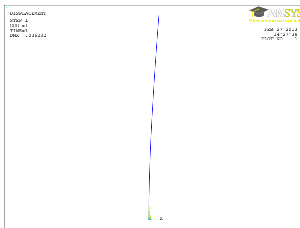
Рис. 3.1. Изгиб стержня под действием горизонтальной точечной нагрузки.
