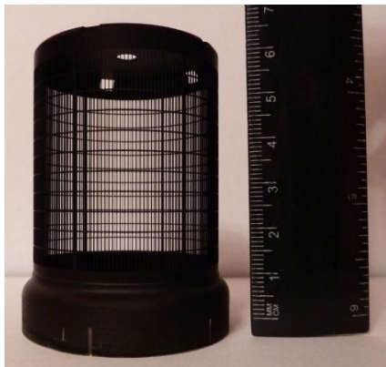
Рис. 8. Вторая сетка генераторной лампы ГУ–138Б
