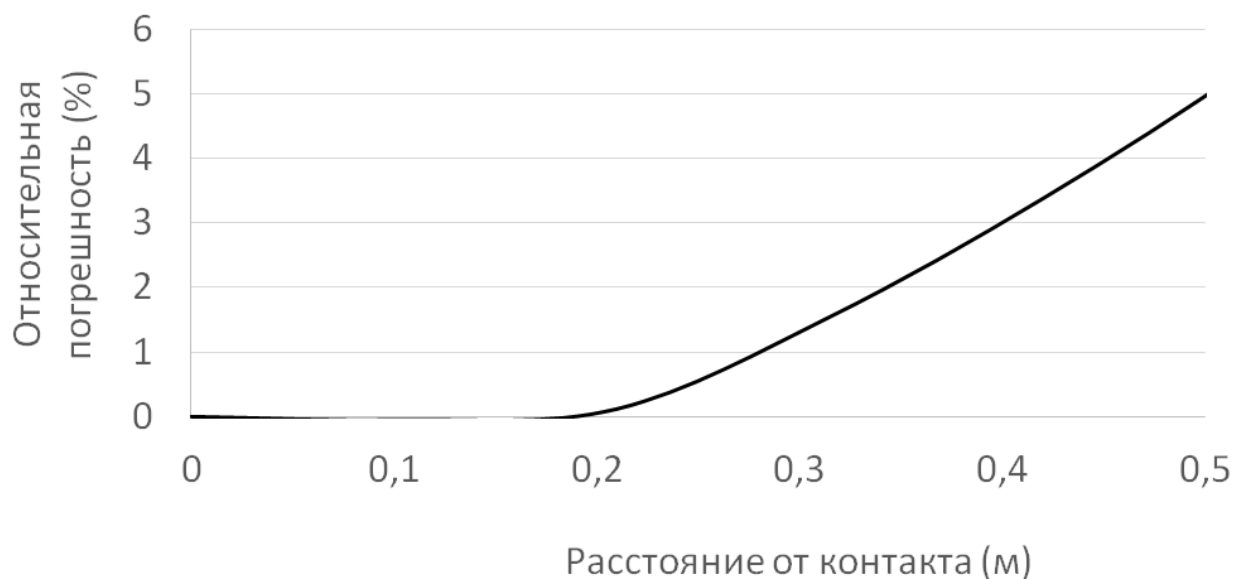
Рисунок 6. Относительная разность между результатами моделирования и расчетом температуры по формуле Хольма-Кольрауша для случая с охлаждением.
