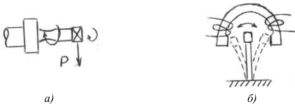
Рис. 3.34. Нагружение образцов: а – мягкое; б – жесткое
