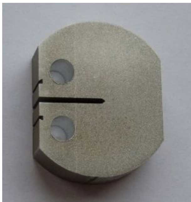
Рис. 4.23. Образец из алюминиевого сплава АК4-1 для испытания на статическую трещиностойкость
