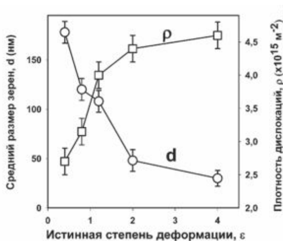
Рис. 1.35. Зависимость плотности дислокаций и среднего размера (суб)зерен от степени деформации [26]
