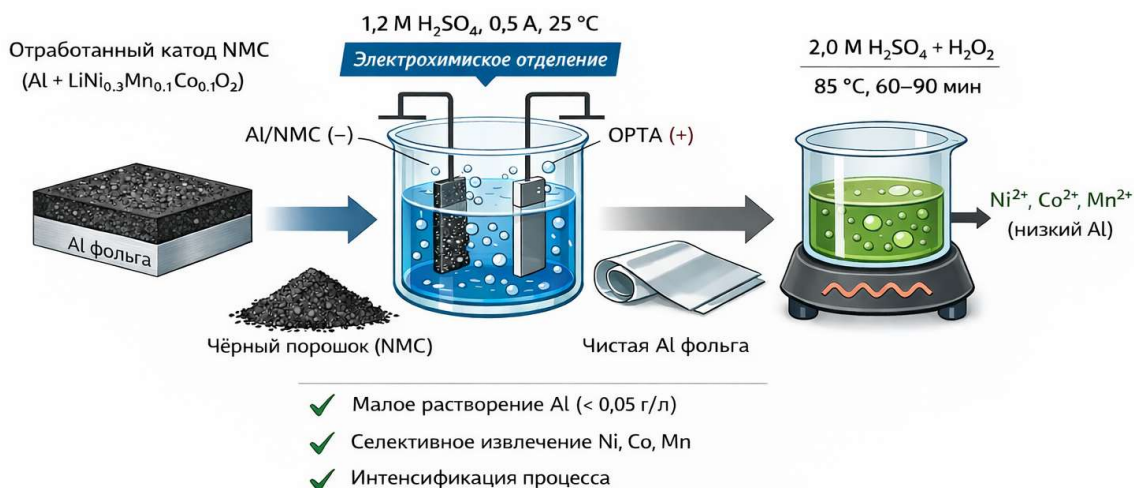
Рисунок 1. Схема двухстадийной переработки катодного материала NMC: электрохимическое отделение активного слоя от алюминиевой фольги с последующим кислотно-пероксидным выщелачиванием.
