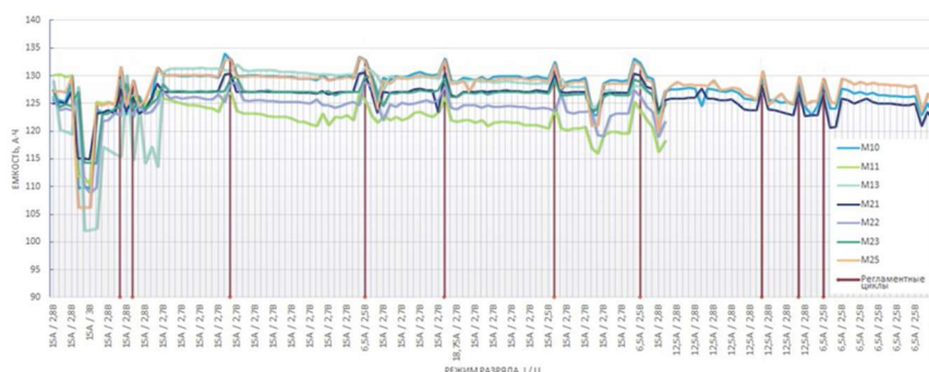
Рисунок 1. Динамика изменений емкости погружных LFP аккумуляторов в различных режимах и условиях проведения зарядно-разрядных циклов за период с 03.2023 г. по 08.2026 г.
