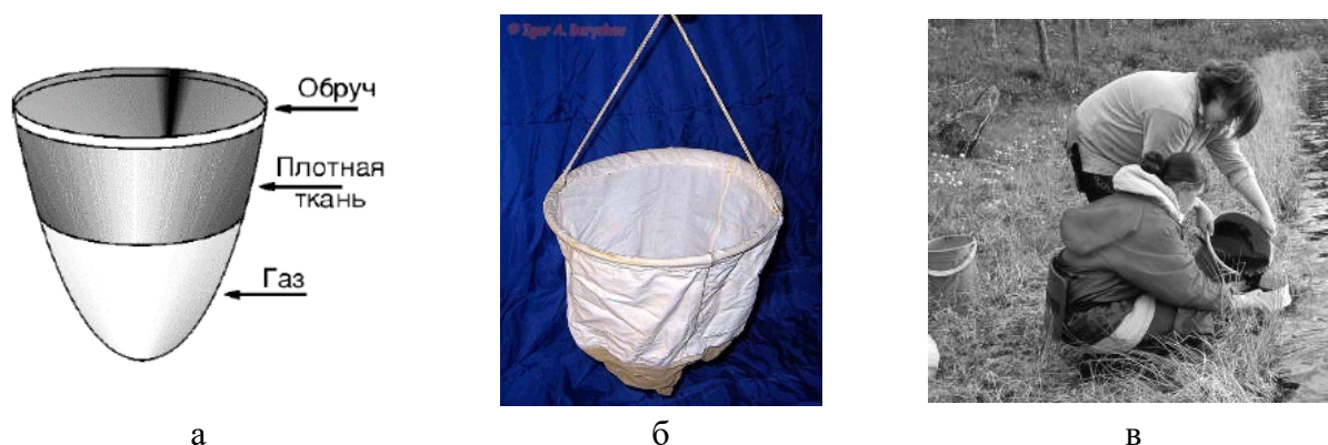
Рисунок 10 – Промывной сачок (а, б и в) последовательная промывка пробы большого объема с помощью сита
