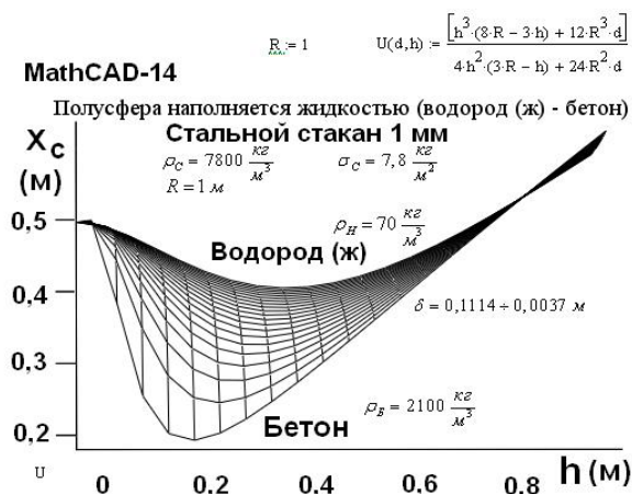
Рис. 3. Смещение центра масс полусферического стакана при наполнении водородом-бетоном
