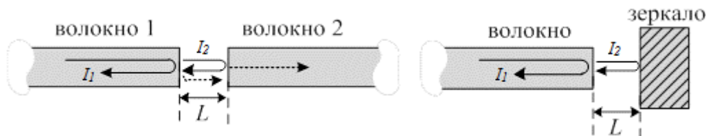
Рис. 1. Схема ВИФП на основе торцов двух волокон и на основе торца волокна и внешнего зеркала
