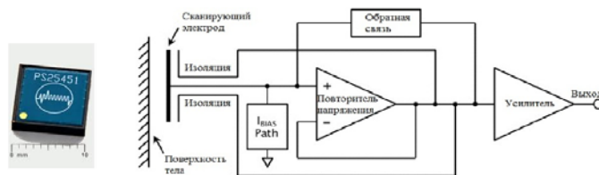
Рис. 3. Датчик электрического потенциала. Схема датчика
