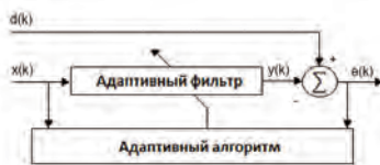
Рис. 1. Пример схемы радиолокационного устройства с адаптивным фильтром и методом DNN.
