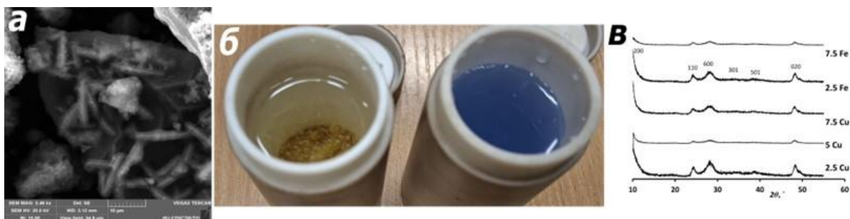
Рис. 1 Изображение СЭМ образца Fe 5% ( 0.95\text{TiO}_2\text{--}0.05\text{Fe} ). Изображение образцов Fe 5% и Cu 5% после ГТО, дифрактограммы образцов. Индексы hkl указаны согласно JCPDS 57-0123.
