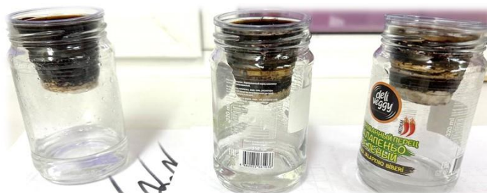
Рис. 1. Внешний вид фильтров, полученных из мишени состава \text{MgO-ZnO-TiO}_2 при температуре термообработки 650^\circ\text{C} , 600^\circ\text{C} и 500^\circ\text{C}
